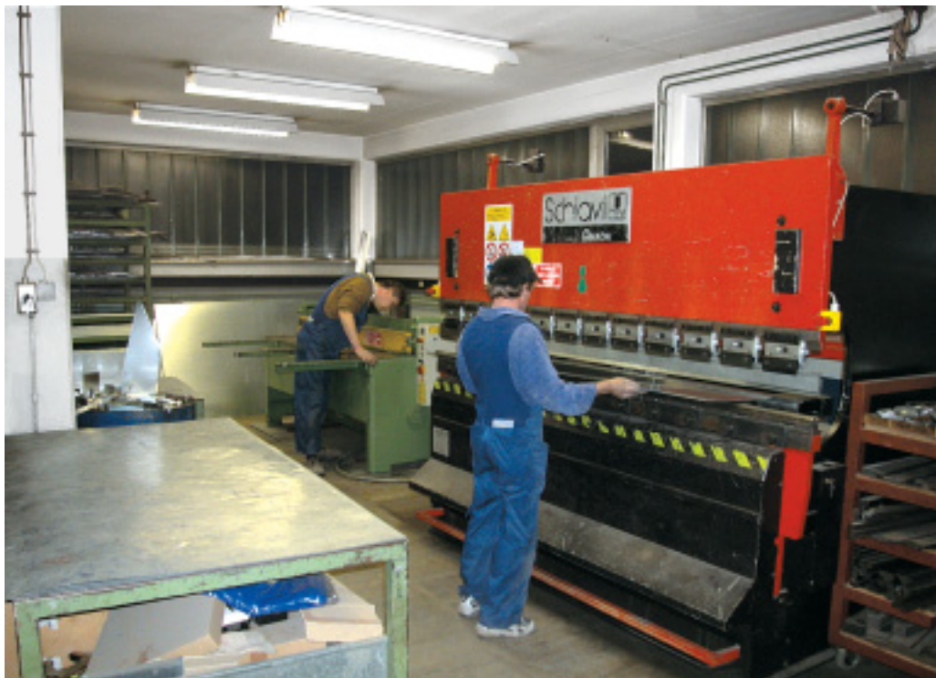
Delavnica za izdelovanje zračnih kanalov.
